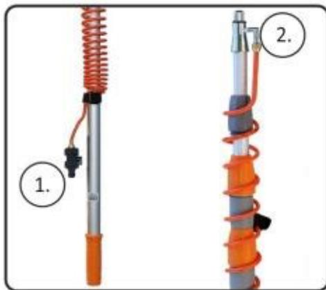
**Schritt 2: Montieren des Spiralschlauchs.** Um den Spiralschlauch zu montieren müssen Sie diesen einfach nur über die Stange schieben. Sie sollten 2 Dinge beachten. Das schwarze Anschlussstück (1) für Ihren Gartenschlauch muss unten an der Stange hängen. Das silberfarbene Metallstück (2) muss ganz oben auf die ausziehbare Stange geschraubt werden. Tipp: wenn Sie die Stange ausfahren, fahren Sie am besten die untersten Abschnitte mehr aus als die oberen, um extra Stabilität zu erhalten.
